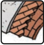
Voûte catalane en brique
