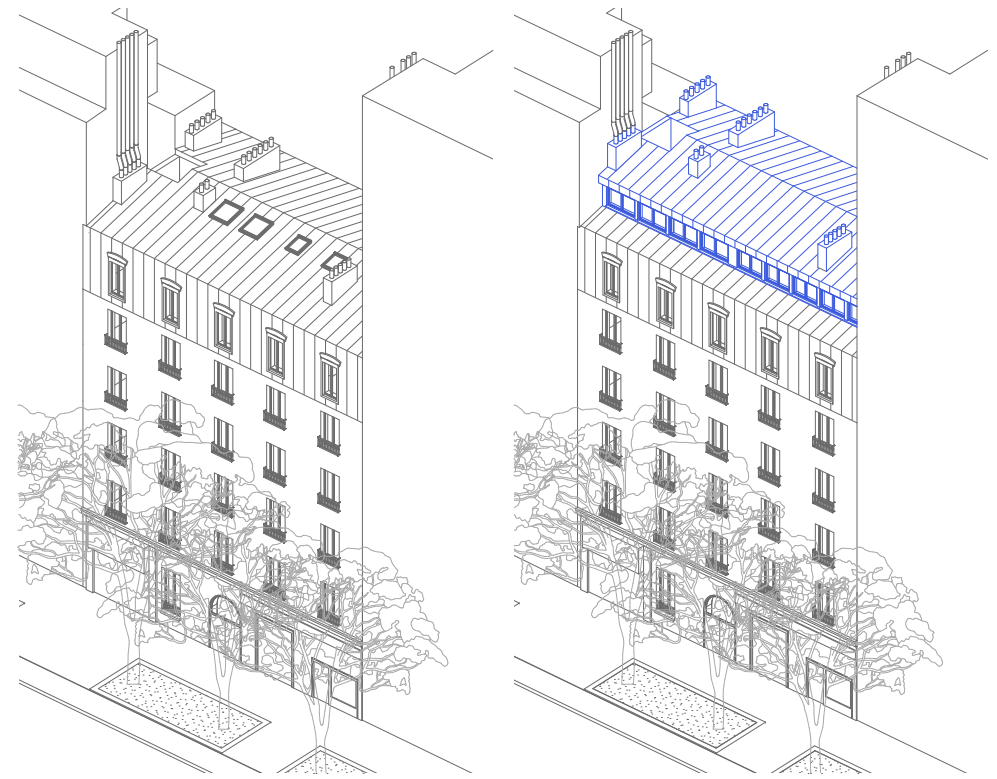
surrélévation partielle d'un immeuble (ossature bois) - Paris (75019) - 2023
